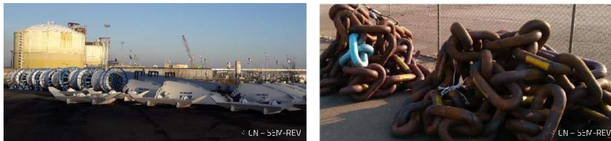
FIGURE 7 : PHOTOGRAPHIES DES DIFFERENTS COMPOSANTS DES LIGNES D'ANCRAGE DE L'EOLIENNE FLOATGEN.
