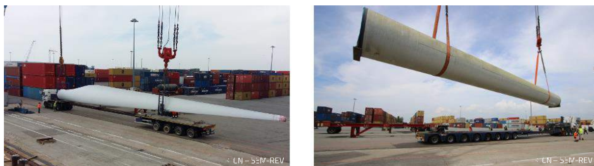
FIGURE 6 : PHOTOGRAPHIES D'UNE PALE (A GAUCHE) ET DU MAT (A DROITE) DE L'EOLIENNE FLOATGEN.
