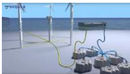
Segula Technologies : stockage d'énergie par air comprimé REMORA®
