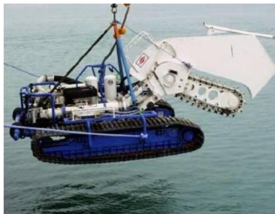
Figure 18 : exemple de trancheuse mécanique
