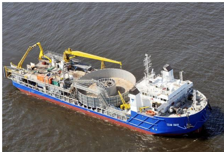
Figure 21 : illustration d'un navire posant des câbles - Source : Global Marine System
