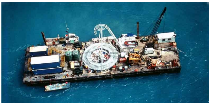
Figure 20 : exemple d'une barge de pose
