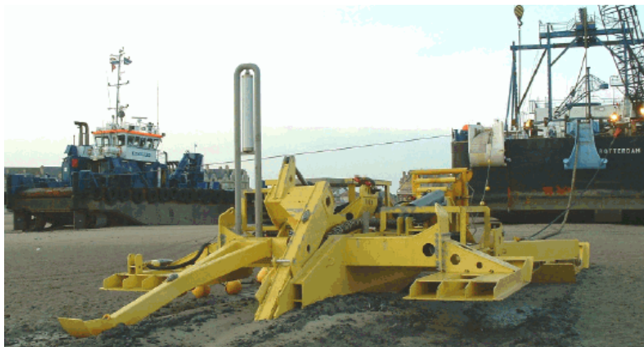
Figure 14 : exemple de charrue (schéma de principe et photographie)
