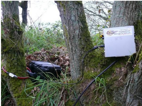
Dispositif d'enregistrement : Batterie longue durée en noir et enregistreur SM2 Bat + en gris sur le site de La Méaugon (22)
