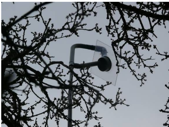
Micro et dispositif de protection placé au bout d'une perche de 10 mètres
