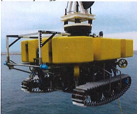
Photo 2 : Engin de water-jetting
