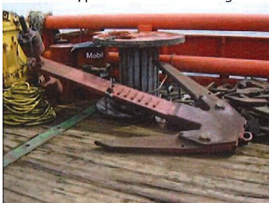
Photo 5 : exemple de grappin utilisé pour une opération de « Pre Lay Grapple Run »
