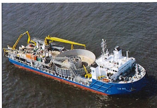
Photo 9 : navire posant des câbles
