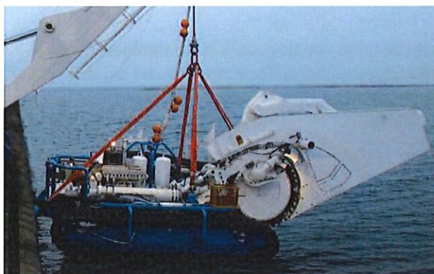
Photo 4 : trancheuse mécanique à roue
