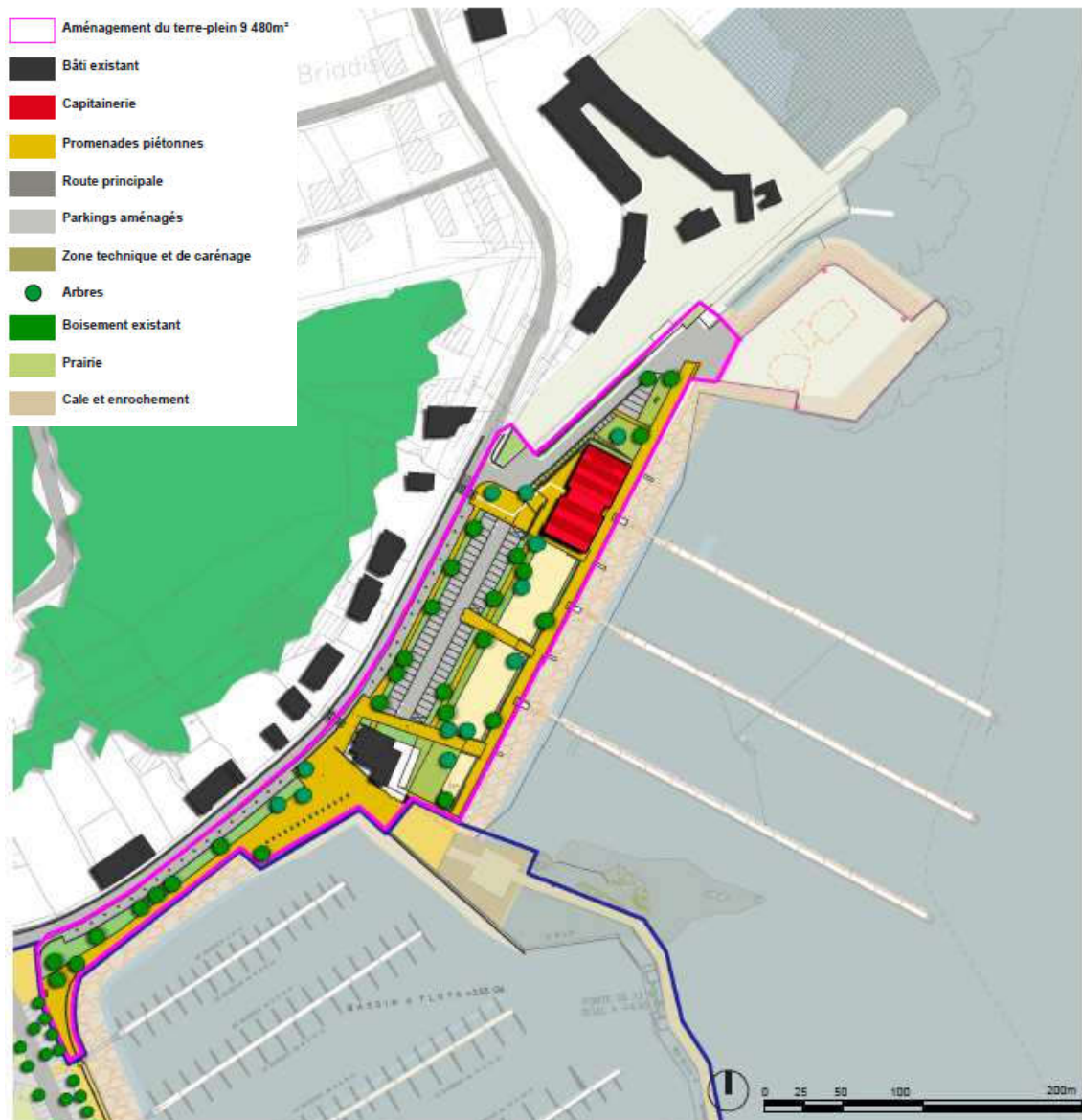
Figure 5-3 : Programme de travaux. Source : URBICUS
