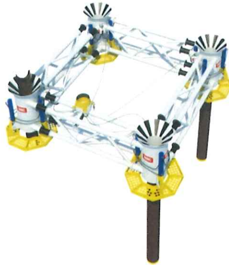
Figure 13 : Cadre permettant l'installation des pieux d'une fondation Jacket
